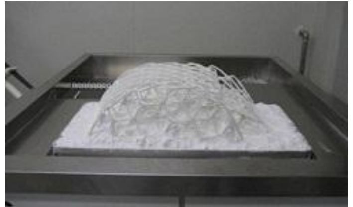
1Figure 17 / Impression 3D SLS ; le laser est utilisé pour solidifier et lier des grains de plastique, de céramique, de verre, de métal ou d'autres matériaux en couches pour produire un objet 3D.
