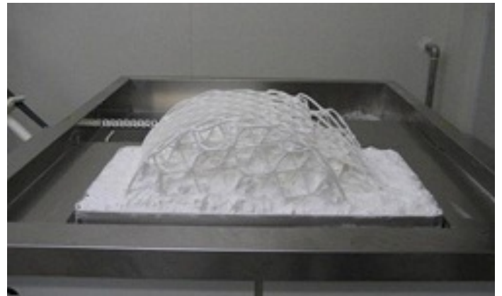
Σχήμα 17 / Τρισδιάστατος Εκτυπωτής SLS, όπου το λέιζερ χρησιμοποιείται για να στερεοποιήσει και να συνδέσει κόκκους από πλαστικό, κεραμικό, γυαλί, μέταλλο ή άλλα υλικά σε στρώματα για την παραγωγή ενός τρισδιάστατου αντικειμένου.
