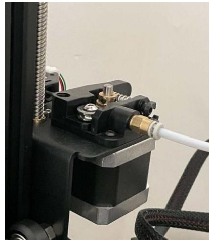
Figura 20 / Estrusore di una stampante 3D
