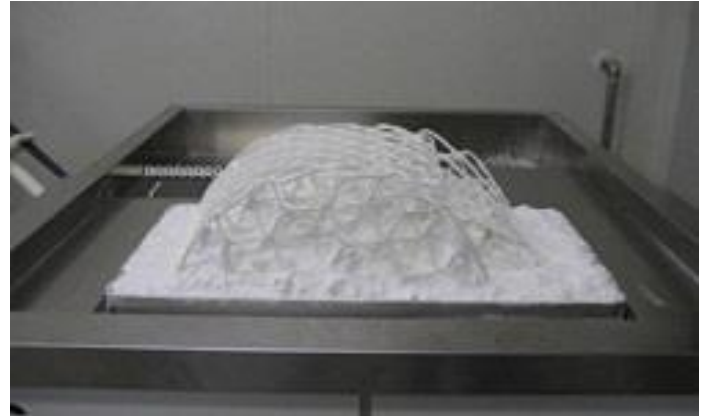
Figura 17 / Stampa 3D SLS; il laser viene utilizzato per solidificare e incollare grani di plastica, ceramica, vetro, metallo o altri materiali in strati per produrre un oggetto 3D.
