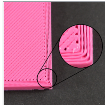
extrudeuse trop froide
