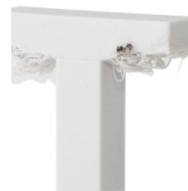
Sans support, l'imprimante FDM dépose du matériau dans les airs et échoue à imprimer la lettre T
