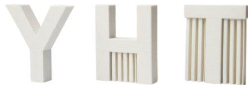
Modèles de Y, H et T imprimés avec supports par une imprimante FDM
