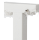
Χωρίς υποστήριξη, ο εκτυπωτής FDM εναποθέτει το υλικό στον αέρα και αποτυγχάνει να εκτυπώσει το γράμμα T
