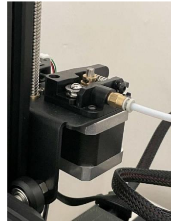
Figura 4 / Estrusore di una stampante 3D
